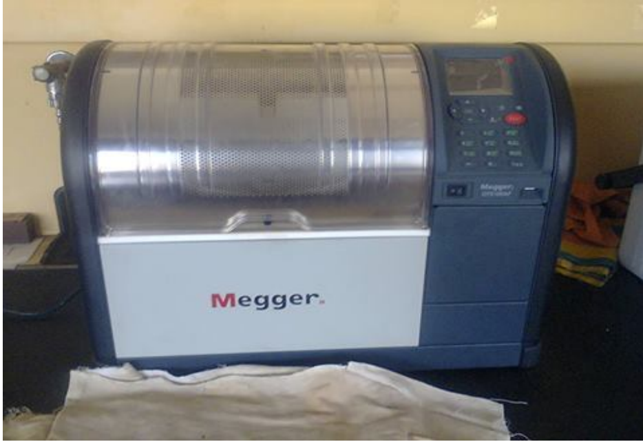
جهاز الميجر الخاص باختبار كسر عينه الزيت وسوف نتعرض لكل هذه الاجهزه مع محاضرات الاختبارات
