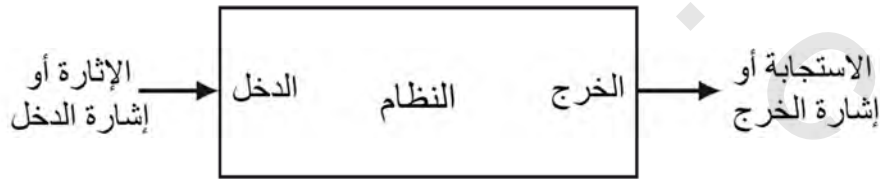
شكل رقم (١,١) مخطط صندوقي لنظام وحيد الدخل وحيد الخرج
