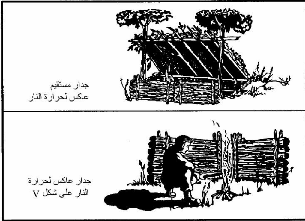
شكل 7-1 أنواع الجدران العاكسة لحرارة النار
