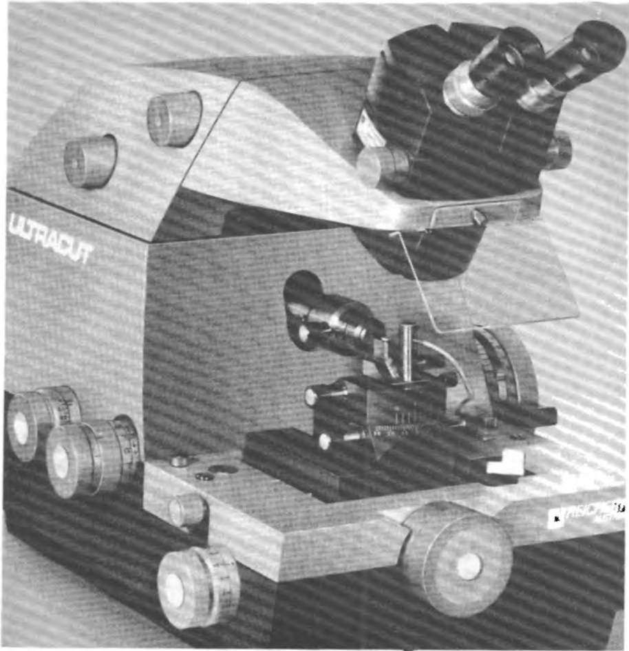
شكل ١٠ - ٤ : جهاز تحضير القطاعات الرقيقة المستخدمة للفحص في المجهر الإلكتروني النفاذ (الصورة من شركة ريختر)
